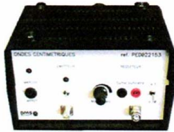
Fig.3. : coffret contenant l'alimentation pour l'émetteur, le circuit amplificateur pour le détecteur et une sortie pour voltmètre
