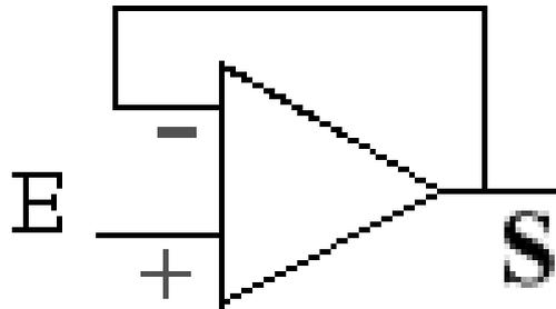
ce circuit permet d'obtenir un circuit simple d'impédance d'entrée infinie et d'impédance de sortie nulle et de gain unité : **suiveur de tension**
