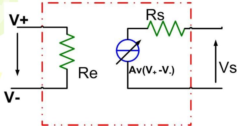
**La résistance ou impédance de sortie est nulle ou très faible :  $R_s \sim 10$  à  $500 \Omega$**
