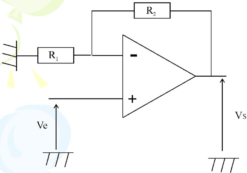
$R_1$  et  $R_2$  forment un pont diviseur entre  $V_s$  et  $V_e$
