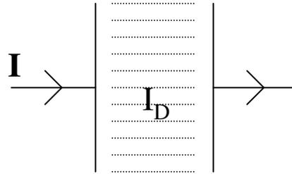
Pour calculer ce courant de déplacement, on détermine d'abord le champ électrique entre les armatures du condensateur :
